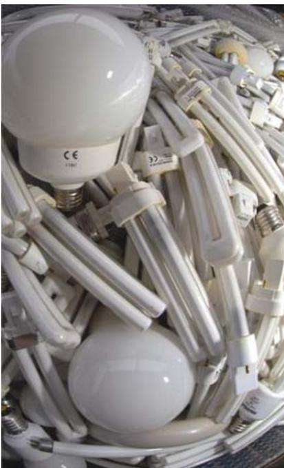
Mittels einer magnetischen Trommel können die Endkappen zu 80 Prozent von den anderen Materialien abgetrennt werden. Die restlichen 20 Prozent der Kappen, die sich aus nicht magnetischen Nicht-Eisen-Metallen zusammensetzen, werden anschließend mit Hilfe eines Altmetallabscheiders ausgetragen.
