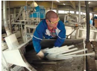
Das Glas kommt in ein so genanntes „Vibrobecken“: Dieses Metallbecken ist schneckenförmig gewandelt und mit Kunststoff beschichtet. Es wird in Vibration versetzt, wodurch sich die Glasscherben von den Leuchtstoff-Bestandteilen abtrennen lassen. Schließlich wird das Glas mit Wasser klargespült.
