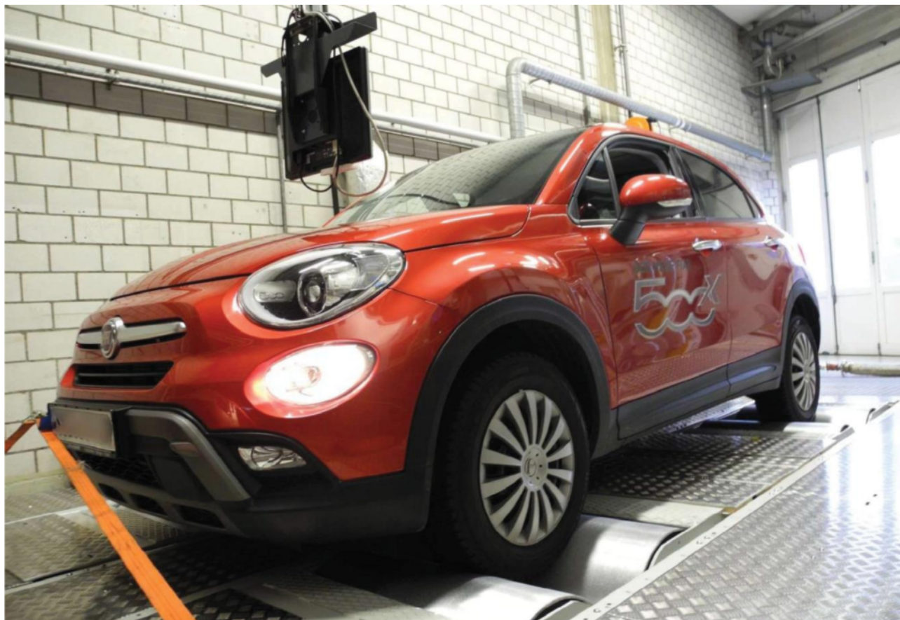
Fig.1: Fiat 500x 2.0 MJ sul banco prova a 4 rulli del centro di controllo dei gas di scarico
