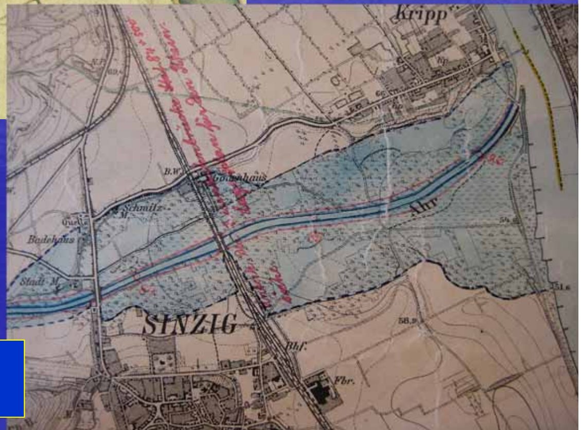
Begradigter Ahrverlauf um 1890 mit Überschwemmungsgebiet
