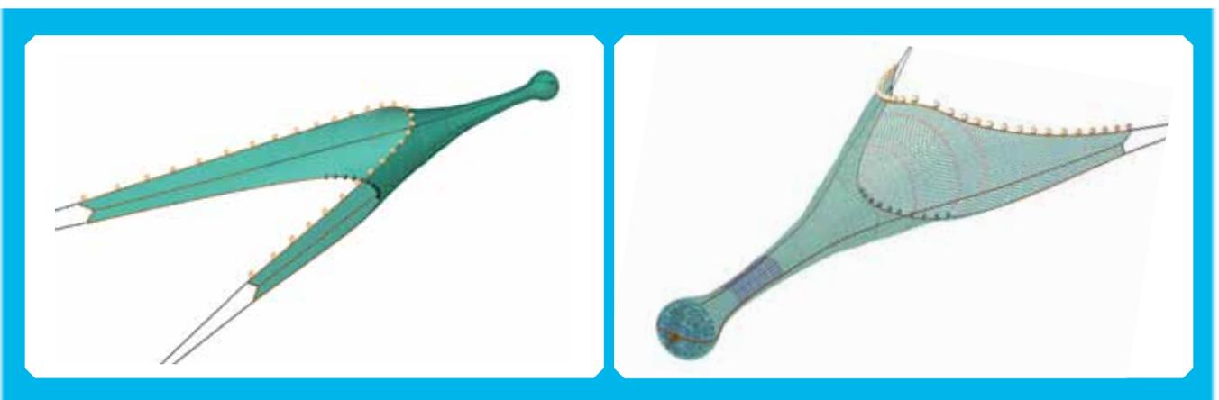
Abb. 28: Beispiele für selektivitätssteigernde Maßnahmen an Schleppnetzen; links: Verkürzung des Oberblatts im „cutaway trawl“; rechts: Quadratmaschen im Steert (Marine Scotland Science, © Crown Copyright (Link 7)).
