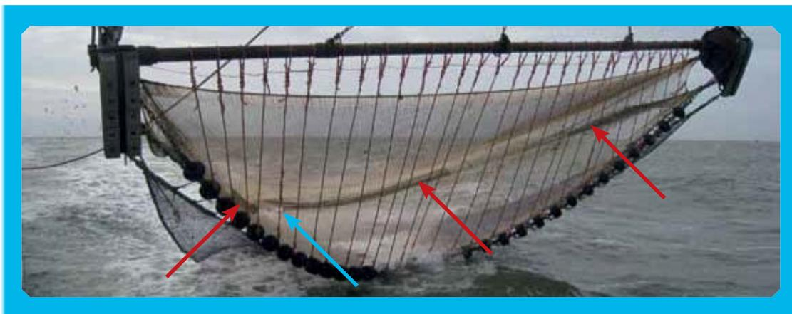
Abb. 29: Garnelen-Baumkurre mit *letter box* zur Verringerung des Schollenbeifangs. Am Netzunterblatt ist ein niedriges Leitnetz (rote Pfeile) angebracht, durch das Plattfische zu einem Ausstieg (blauer Pfeil) an der Unterseite geführt werden. (© IMARES Wageningen UR).
