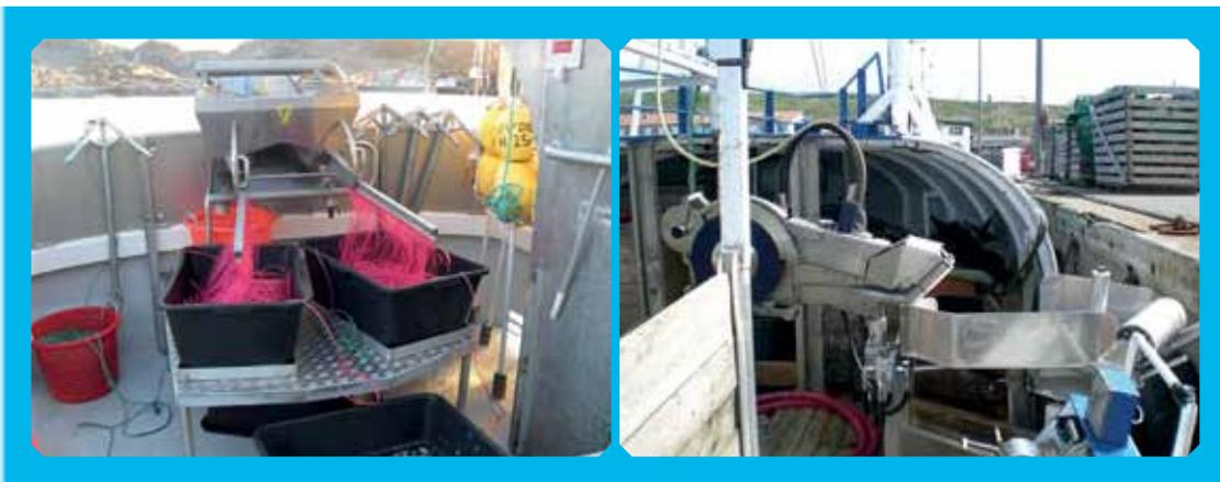
Abb. 32: links: vollautomatisches Beköderungssystem; rechts: Hol- und Separiersystem (© www.oilwind.fo).
