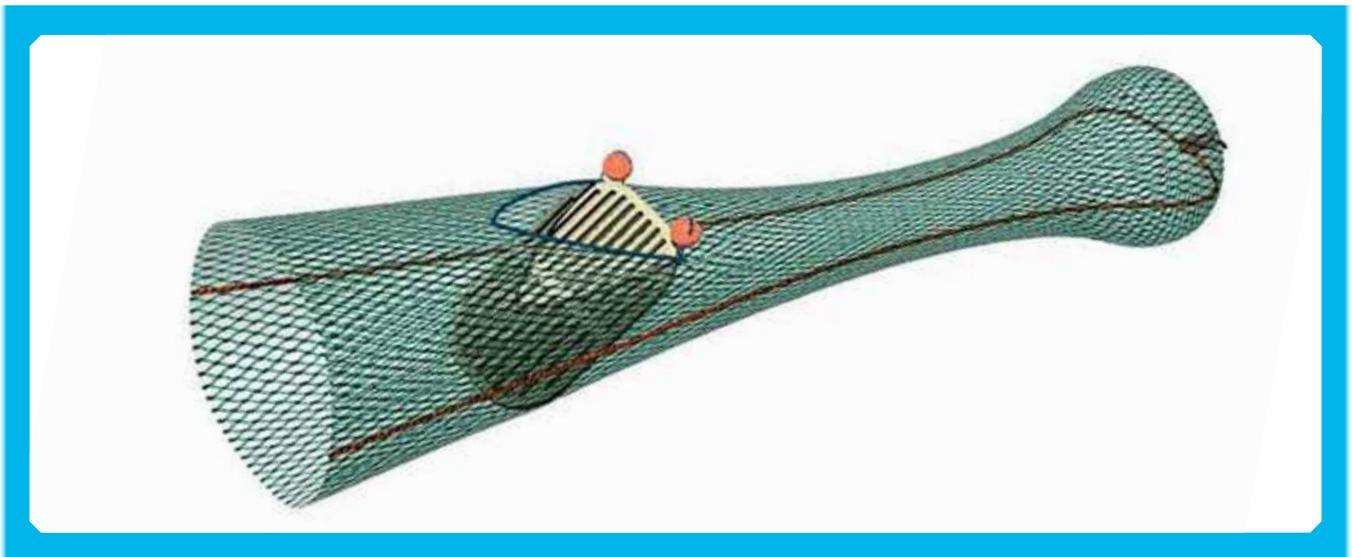
Abb. 30: Sortiergitter mit Entkommensöffnung vor dem Steert (Marine Scotland Science, © Crown Copyright (Link 7)).
