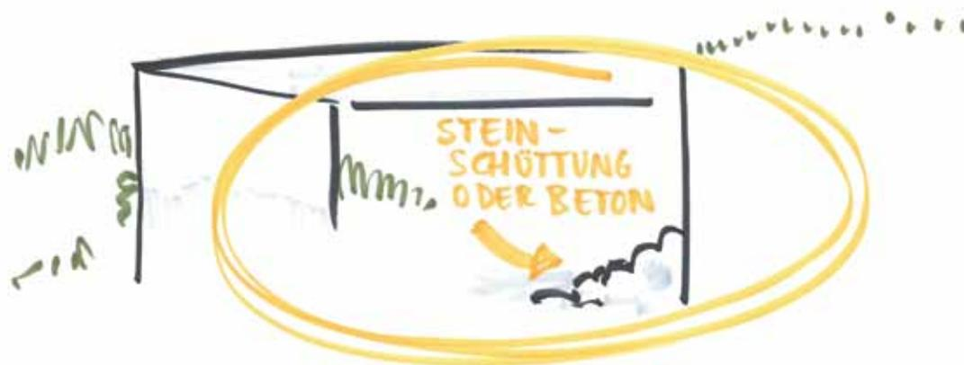
Der einfachen Schüttung einer Berme ist das Setzen der Steine und die nachträgliche Verfüllung der Hohlräume vorzuziehen. Mit dieser Variante lassen sich sehr gut eine ebene Fläche und die Anbindung an das Ufer gewährleisten. Durch das Setzen
