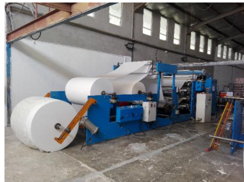
Fertiges Papier wird zur Weiterverarbeitung auf Rollen gewickelt. © Sammutawe
