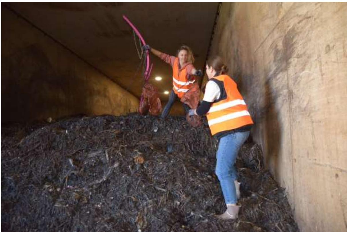
Abbildung 5: Austragen der Proben am 02.11.2022 (Rottenetze an Metallketten und Markierungsstäben).
