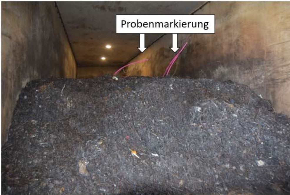
Abbildung 4: Blick in die Tunnelkompostierung. Eingesetzte Proben befinden sich an Metallketten am Stab.
