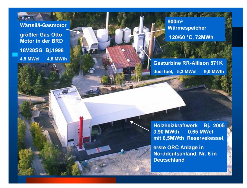
Organic Rankine Circle: Thermodynamischer Kreisprozess bei niedrigen Drücken (~1 bar) und Temperaturen (< 300°C) mit einem synthetischen Arbeitsmittel (Silikonöl)
