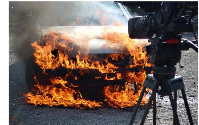
Brennendes Fahrzeug nach einer Leckage von R1234yf im Motorraum.
