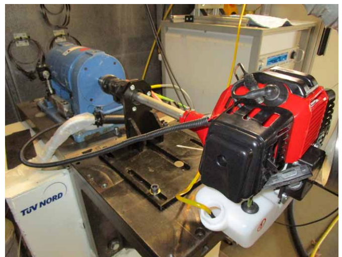
Spannvorrichtung für die Messungen der Emissionen von Motorsägen und Freischneidern.
