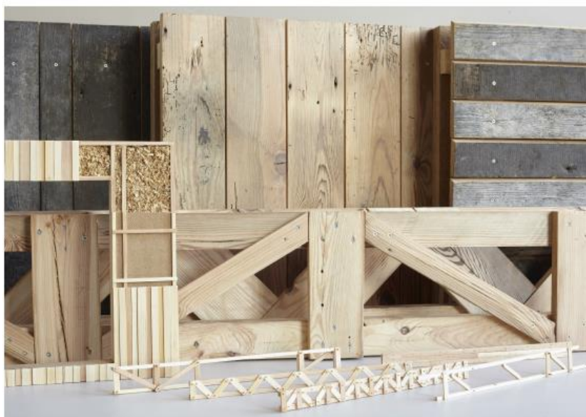
Abbildung 5: Konzeptmuster von Bauteilen aus Altholz. Links im Bild ist eine eingesetzte Holzfaserdämmplatte zu erkennen.
