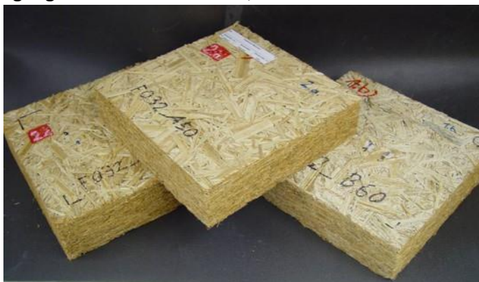
Abbildung 8: Dämmstoffplatten aus Typha Quelle: Fraunhofer-Institut für Bauphysik IBP
