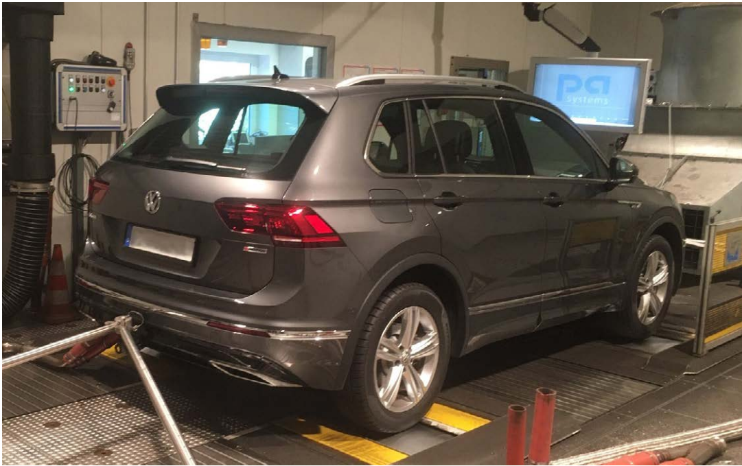
Abb. 2: VW Tiguan 2.0 TDI SCR 4Motion auf dem Rollenprüfstand
