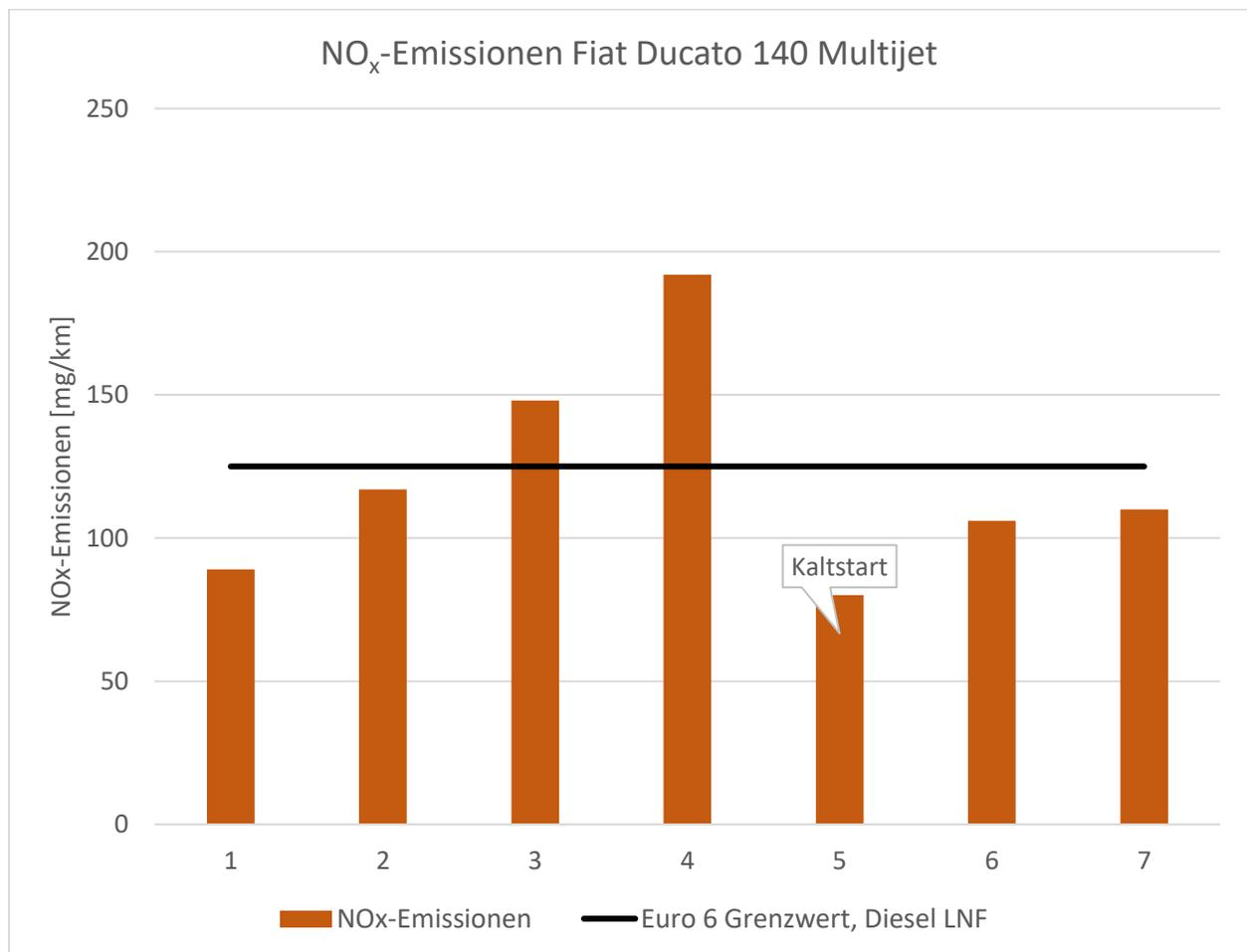
Abb. 3 NO<sub>x</sub>-Emissionen der einzelnen Messungen
