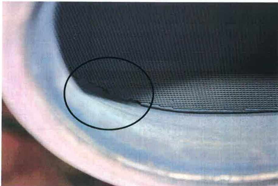
Bild 9: Foto in Dieselpartikelfilter auf NO x -Speicherkatalysator-Seite
