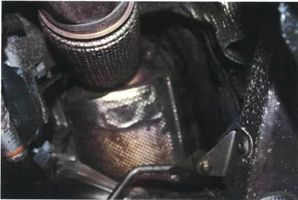
Bild 6: Dieselpartikelfilter in Einbaulage
