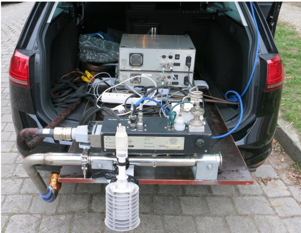
**Abgasmessungen an 36 Diesel- und 3 Benzin-Hybrid-Pkw, Euro 6**
