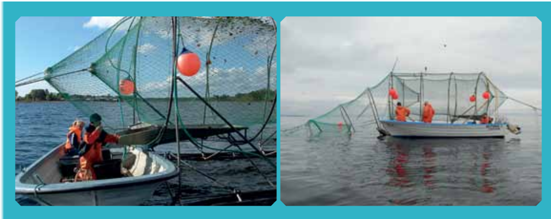
Abb. 20: Schwedische Ponton-Hebe-Reuse (Copyright: Harmångers Maskin & Marin AB)
