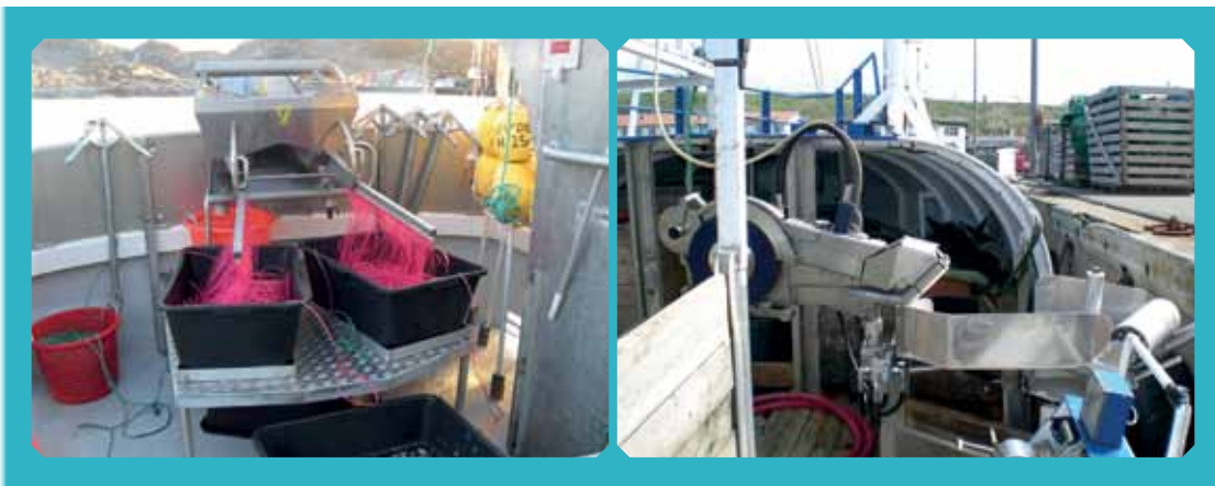
Abb. 15: links: Vollautomatisches Beködierungssystem; rechts: Hol- und Separiersystem (Quelle: www.oilwind.fo )
