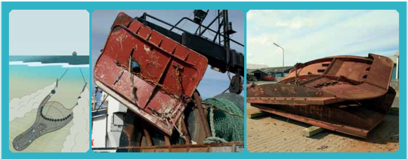
Abb. 12: Grundschieppnetz (Copyright: Morris-Julien/Greenpeace) und typische Scherbretter für Grundschieppnetze.
