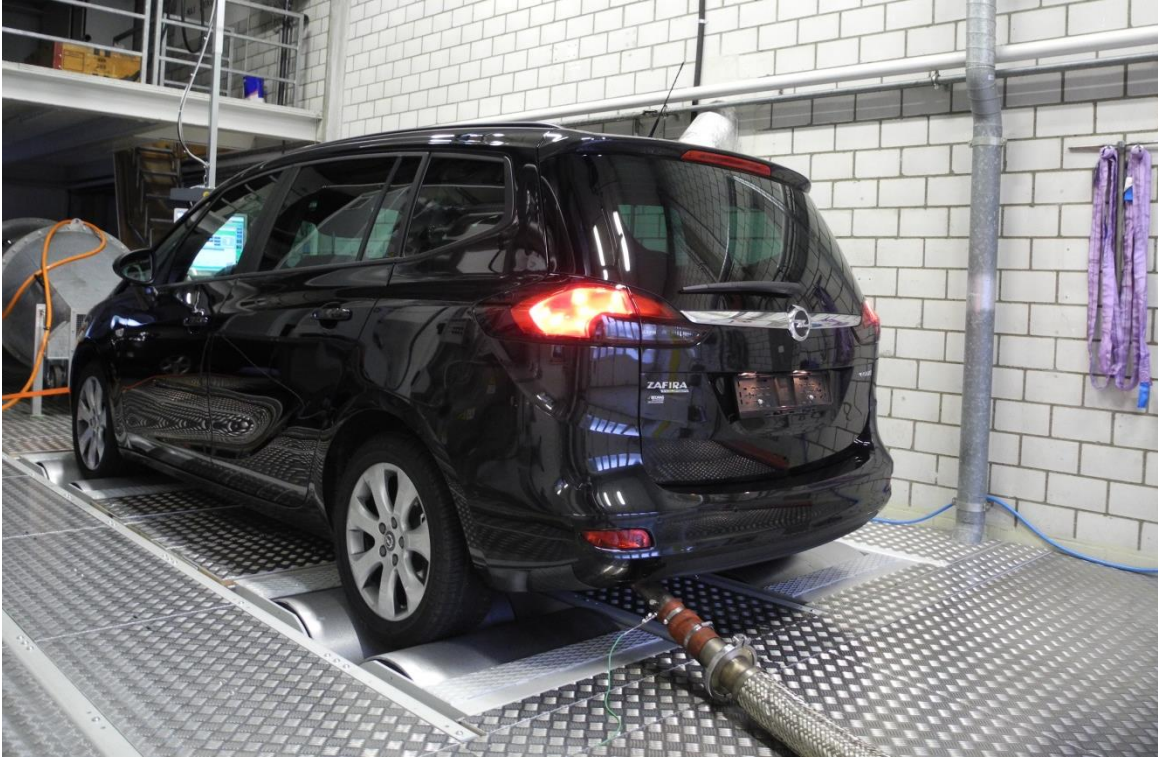
Fig. 1: OPEL Zafira CDTi 1.6 auf dem 4x4 Rollenprüfstand der Abgasprüfstelle
