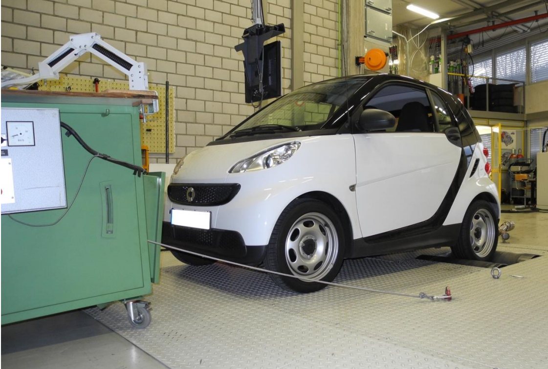
Fig.1: Smart fortwo coupe cdi auf dem Rollenprüfstand der Abgasprüfstelle
