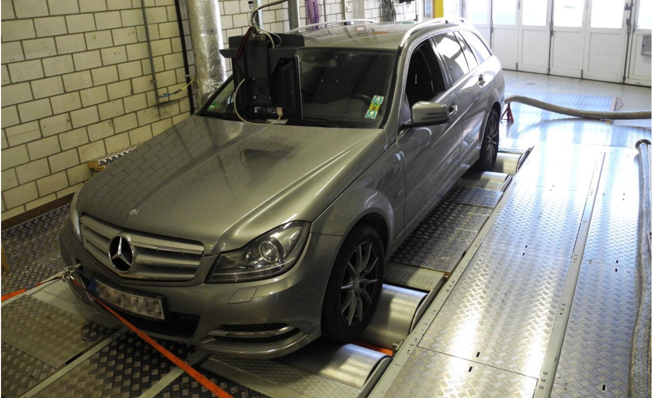
Fig.1: Mercedes-Benz C 200 CDI auf dem 4x4 Rollenprüfstand der Abgasprüfstelle
