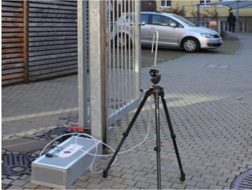
Abbildung 2: Beispiel stationärer Messungen an der Römerschule. Ansaugleitung auf dem Stativ und NO 2 ICAD Messinstrument mit Akkubetrieb daneben.
