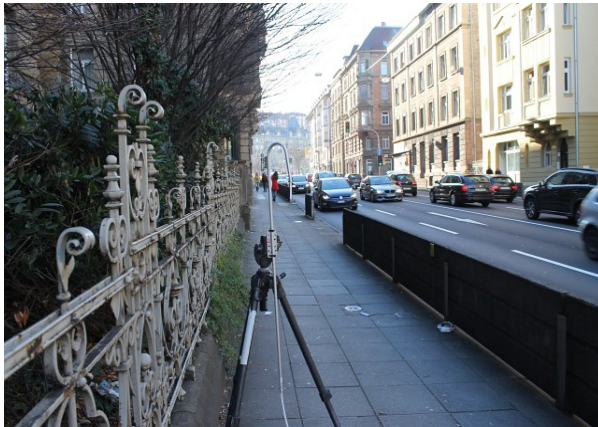
Abbildung 4: Messung an der Fassade der Römerschule zur Richtung Hauptstätter Straße mit dem Stativ und Ansaughöhe ca. 1,5m.
