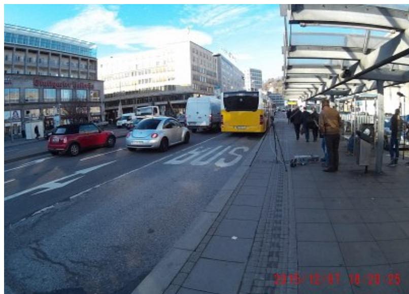
Abbildung 3: Messung an der Bushaltestelle Hauptbahnhof mit dem Stativ und Ansaughöhe ca. 1,5m.
