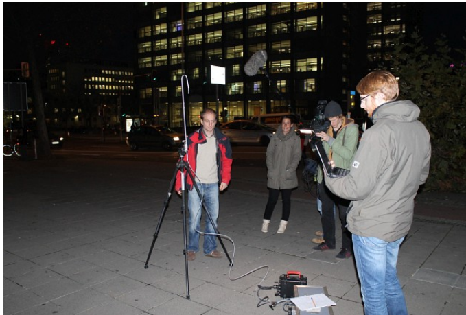
Abbildung 8: Messung vor dem Haupteingang des Katherinen Hospitals mittels Stativ
