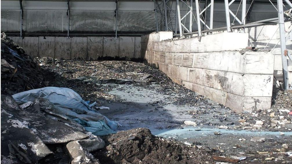
**Abbildung 3: Im Freien gelagertes und von Wasser durchdrungenes Material zur Ersatzbrennstoffherstellung auf dem RCO-Gelände (Foto vom 23.06.2011)**
