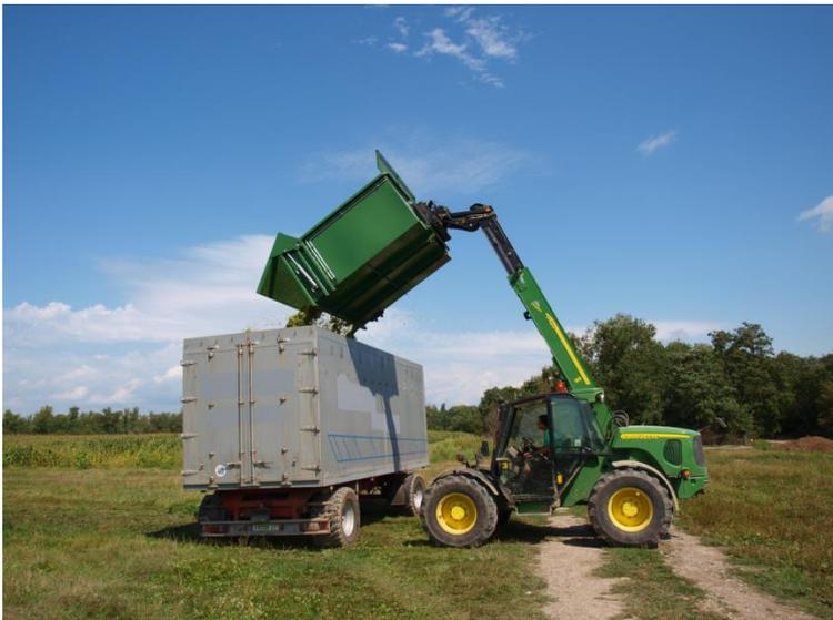
3. Für effizienten Abtransport kippt der Teleskoplader das Material in ein größeres Transportfahrzeug, das den Mais zur Biogasanlage fährt
