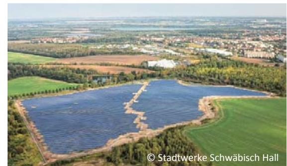
In 2011 haben die Stadtwerke beim Kraftwerksausbau fast ausschließlich „Erneuerbar“ investiert. Die größte Investition war eine Solaranlage mit einer Leistung von 8,5 MW im sächsischen Borna auf einem ehemaligen Truppenübungsplatz. Die 36.480 Module sorgen seitdem für eine CO<sub>2</sub>-Einsparung von jährlich rund 4.160 Tonnen. ■
