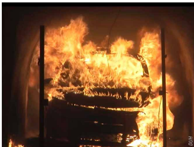
R1234yf kann bei Unfällen gefährliche Abbauprodukte bilden
